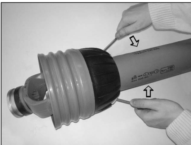
Ouvrez les fermeurs pour dégager la protection
