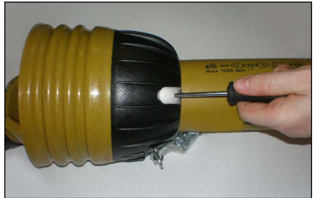
Schieben Sie Schraubenzieher in die Klappen
