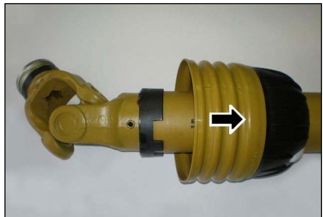
Ziehen Sie den Schutz zurück, um das Gelenk freizulegen
