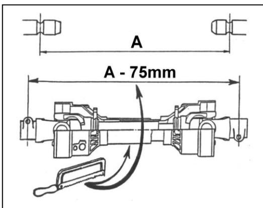
*Von der (am Traktor angeschlossenen) Maschine in Arbeitsposition, den horizontalen Abstand „A“ vom der Traktorwelle bis zum Schaft des Maschinengetriebes messen und 75mm abziehen – diese Ziffer ist die benötigte Schaftlänge.*
