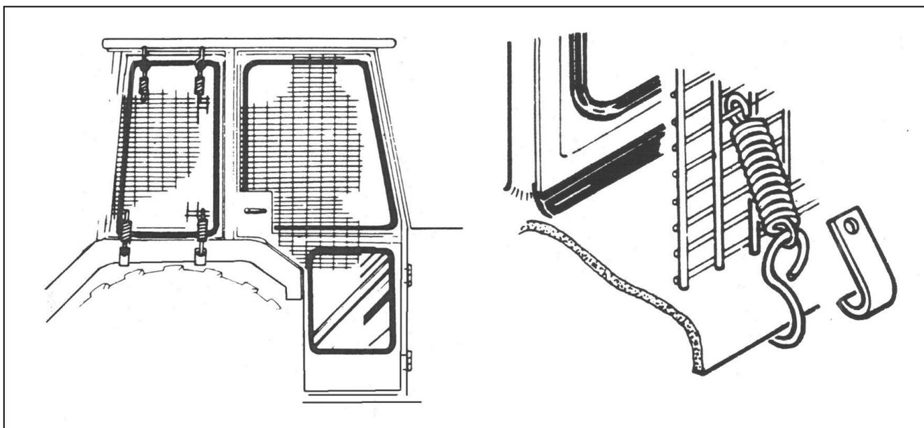
Den Bedienschutz (Teil Nr. 7313324) mit Hilfe der Haken montieren.
