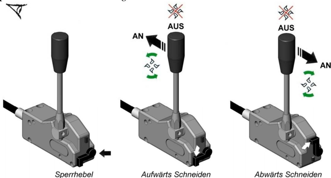
**WARNUNG:** Beim Ausschalten des Rotors dreht dieser noch etwas – in manchen Fällen kann dies bis zu 40 Sekunden oder länger dauern. Niemals der Maschine näher kommen, wenn der Rotor noch dreht.
