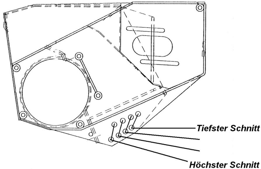
Um die Rolle einzustellen, müssen die Halterungen der Rolle und die Sicherungsbolzen in einer der vier Positionen gestellt werden. Sicherstellen, dass gegenüberliegend die gleichen Löcher genutzt werden.
