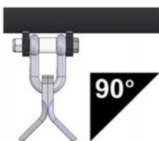
**VORSICHT!** Bei Köpfen mit auf Schäkel befestigten Dreschflügeln sollte das Starten und Stoppen des Rotors mit dem Kopf in der horizontalen Position durchgeführt werden; Dadurch wird die Gefahr vermieden, dass äußere Schlegel beim Anlaufen und Abbremsen des Rotors mit der Seitenverkleidung in Berührung kommen. Nichtbeachtung führt zur Beschädigung von Gehäuse und Schlegeln.
