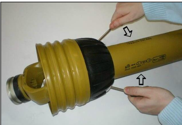
Klappen hochwuchten um den Schutz zu lösen
