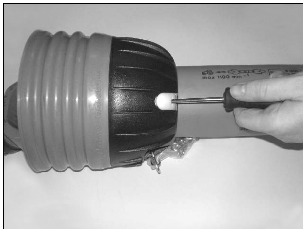
Insérez les tournevis dans les fermoirs
