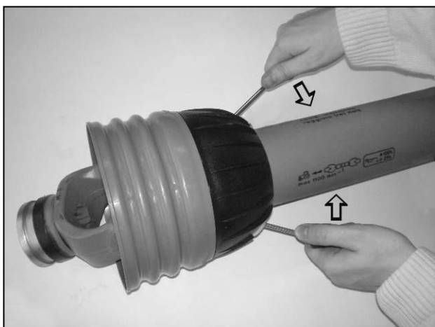
Ouvrez les fermoirs pour dégager la protection
