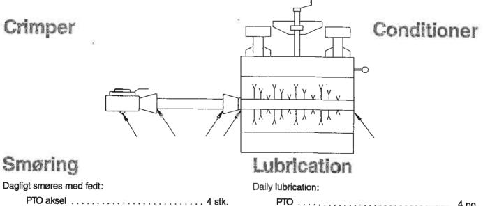
Crimper ...... 2 stk. Gearkassen er fyldt med »Shell Alvania RO« specialfedt.
