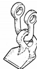
Der Schlegelkopf wurde für eine höhere Stabilität und längere Haltbarkeit doppelwandig konstruiert. Der Antrieb durch die Keilriemen vom Hydraulikmotor zum Rotor, liegt für einen sauberen Schnitt vollständig innerhalb der Kopfbreite.
