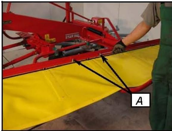
**SLO** Pred montažo zavese na nosilec odvite vijaka M10x30 in matice M10 (poz. A).
