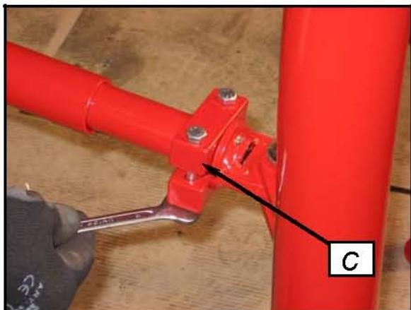
**SLO** Na stabilizator privijačite omejevalo (poz. C) z dvema vijakoma M8x65, podložkama in maticama M8.
