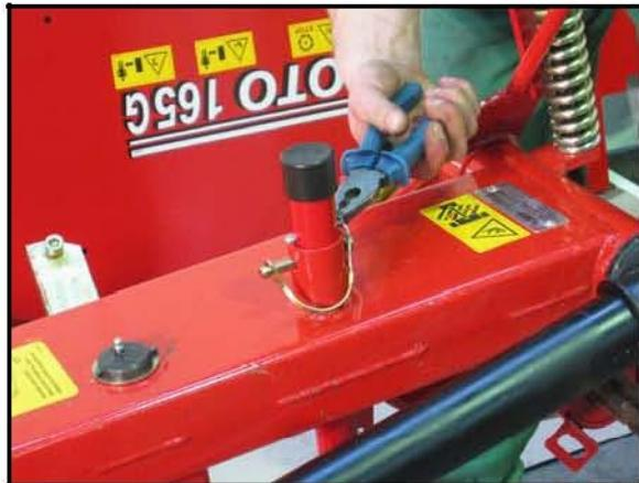
**SLO** Vstavite podporno nogu in jo zavarujte s traktorskim zatikom, razcepko 5x50 in pokrovom plastičnim.
