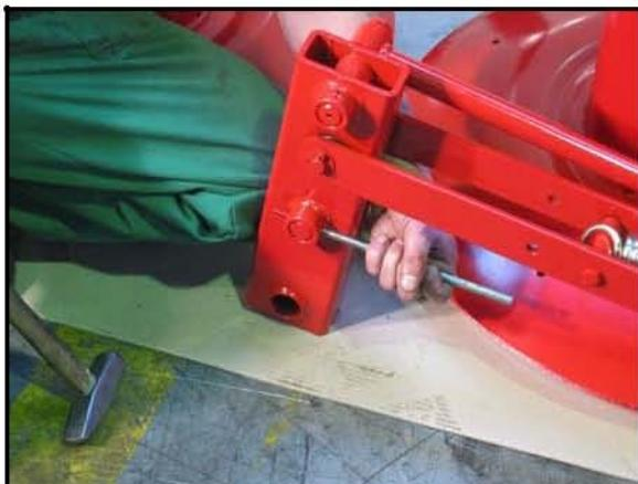
**SLO** Z nosilnega vzdovovja odstraniti vzmetni zatič 8x45.
