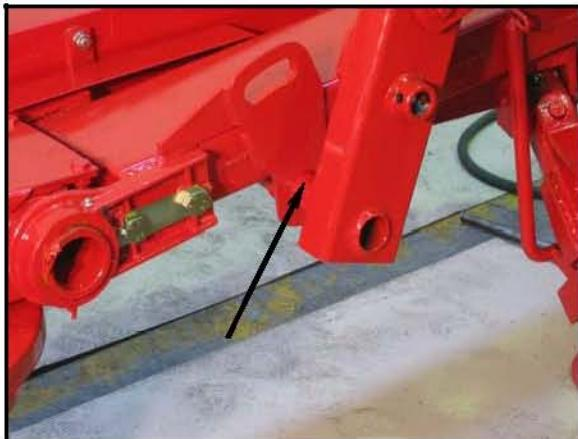
**SLO** Cev vzdovovja nosilnega vstavite skozi ušes na nosilcu. Na cev vzdovovja namestite podložko 43,5/60-3; varovanje izvedite z razcepko 6x63 (dobro jo uvijte okoli cevi).
