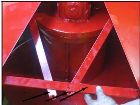
**SLO** Pritrditev vezi pod krovne pločevine. Vijake pritrdite končno takrat, ko boste imeli montirane vse krovne pločevine.
