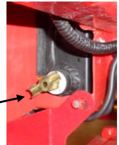
Radiatoraftapkraan gezien vanaf de rechterzijde van het chassis
