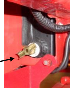
Robinet de vidange du radiateur vu depuis le côté droit du châssis
