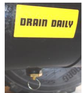
Réservoir d'air avec robinet de purge
