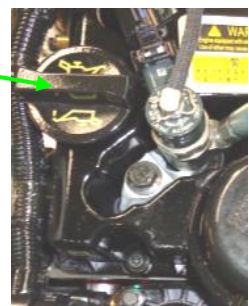
Bouchon de remplissage d'huile de lubrification Vers le côté avant droit du cache-culbuteurs
