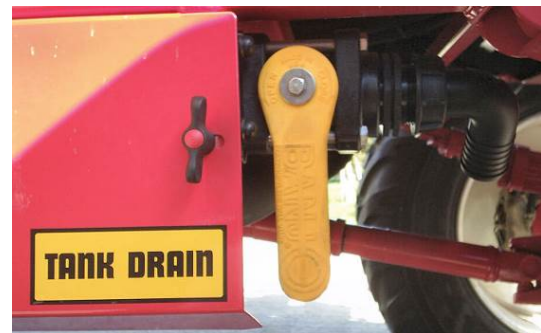
Purge du réservoir
