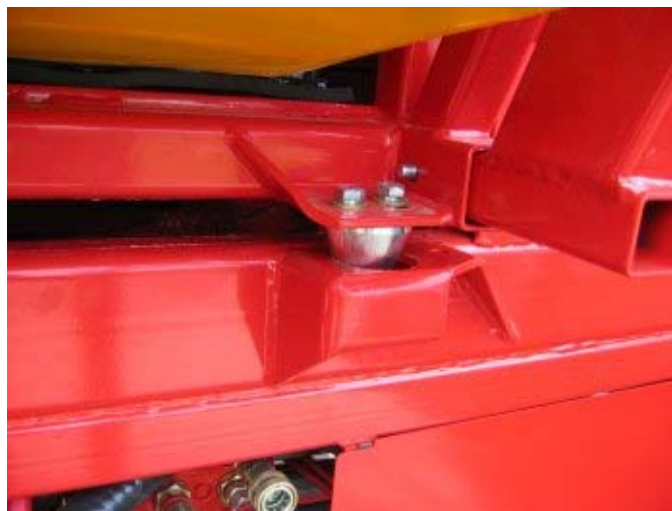
Le système de guidage par cône aligne automatiquement le cadre de dépose lors du remontage
