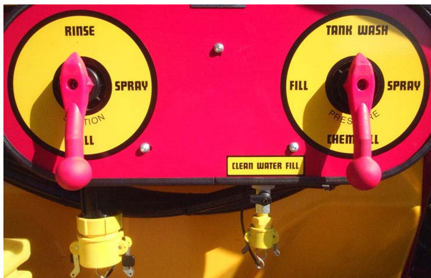
Positions des vannes pour le lavage du réservoir
