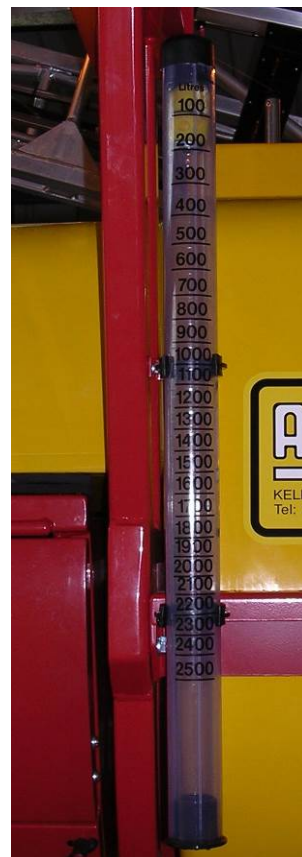
Jauge à niveau visible du réservoir
