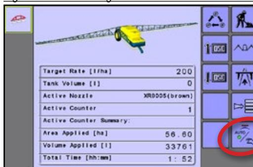
Figure 2-2 : Mode régulation sur l'écran Fonctionnement
