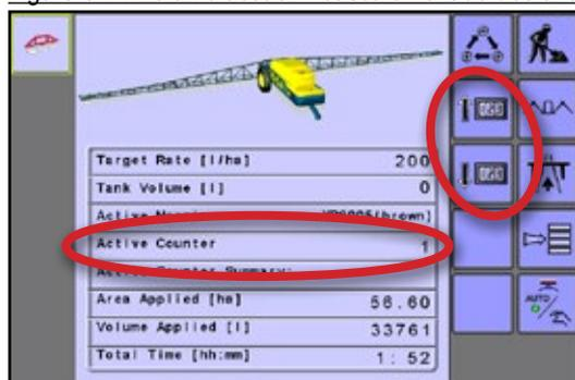
Figure 3-2 : Numéro de compteur de déclenchements actifs sur l'écran Fonctionnement
