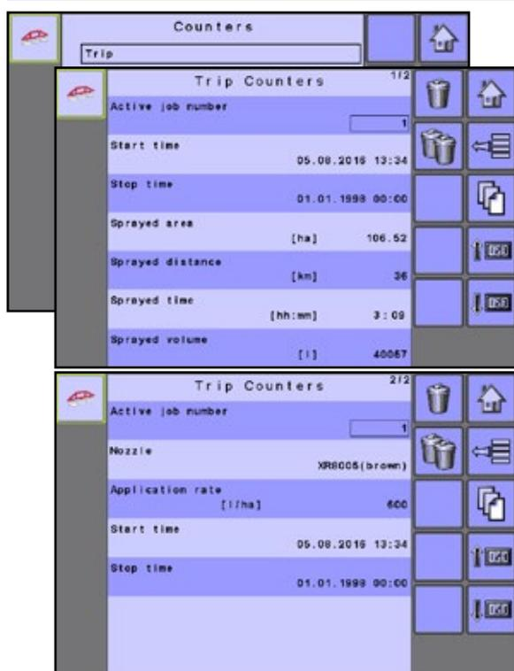
Figure 6-4 : Menu Compteurs de déclenchements en mode TC
