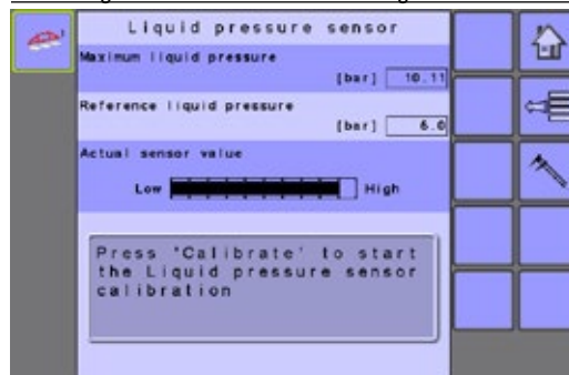
Abbildung 3-21: Kalibration des Flüssigkeitsdrucksensors
