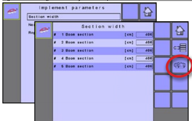
Figure 3-12 : Largeur de tronçon de rampe
