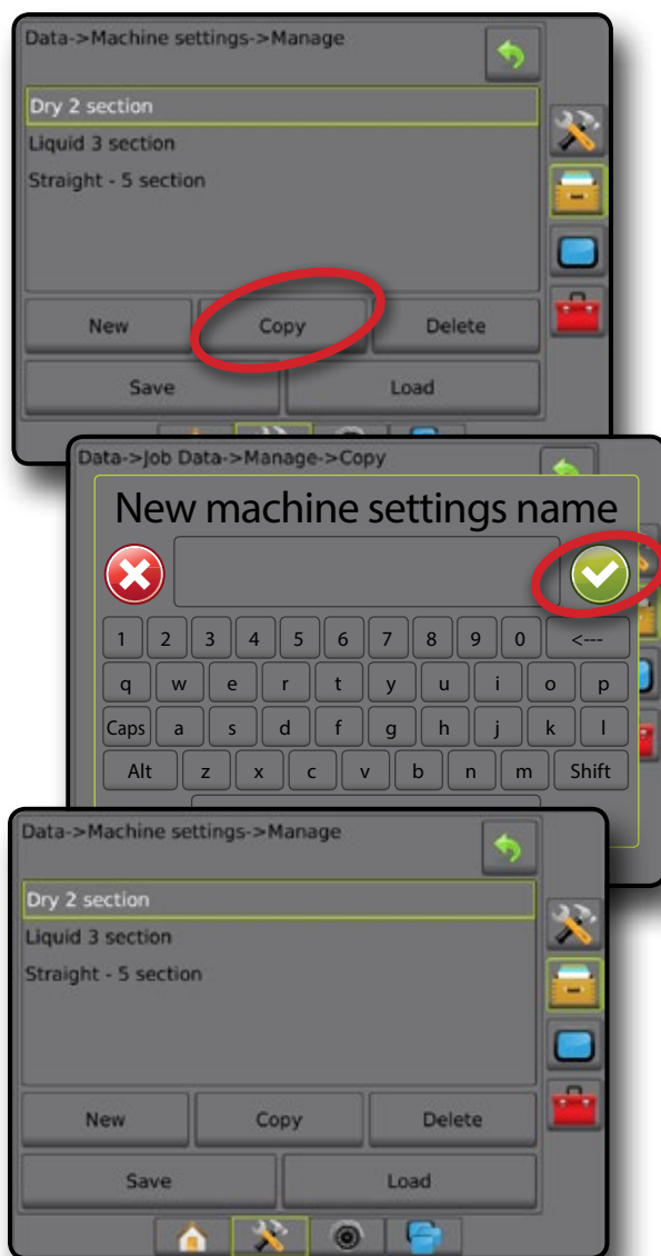
Figure 34 : Paramétrage machine – Copier le profil
