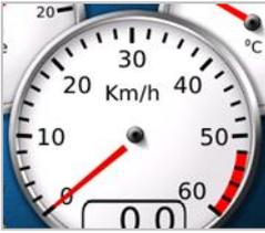
Der Tachometer im Hauptbildschirm ermittelt die Fahrgeschwindigkeit aus der Getriebeausgangswellendrehzahl und werksseitig eingestellten Werten für Getriebeübersetzung und Radgröße. Als Radgröße wird die des größtmöglichen Rades genommen. Ein GPS-Sensor ist ebenfalls vorhanden. Sein Signal wird dazu verwendet, einen Korrekturfaktor zu ermitteln, der die berechnete Geschwindigkeit korrigiert, um die tatsächlich Fahrgeschwindigkeit zu berechnen.
