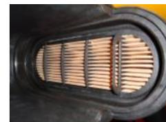
Sekundäres (Sicherheits-) Filterelement
