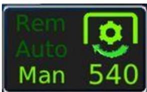
**Automatikmodus** – Im Automatikmodus wird die Drehzahl von der Elektronik überwacht und durch Verstellen des Hydraulikventils auf dem vorgegebenen Wert gehalten. Das Ventil wird unter Beachtung von Temperatur, Druck und Eingangsvolumenstrom verstellt.
