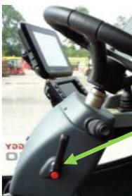
Zum Justieren der Lenkradstellung entgegen dem Uhrzeigersinn am Hebel drücken und die Lenksäule nach vorne oder hinten bzw. nach oben oder unten verschieben, um die am besten geeignete Fahrposition zu finden. Zum Feststellen entgegen dem Uhrzeigersinn am Hebel drücken. Lenkradposition nicht während der Fahrt justieren!
