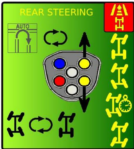
Wenn keine Taste gedrückt wird, schließt sich das Popup-Menü nach 5 Sekunden von alleine. Das Joystick-Symbol in der Mitte zeigt an, welche Tasten zur Verfügung stehen. Sie funktionieren nur, wenn der entsprechende Lenkmodus ausgewählt wurde.
