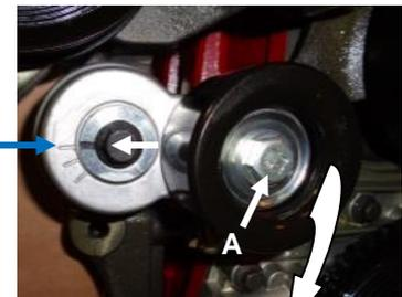
Im Uhrzeigersinn drehen, um die Spannung des Keilriemens zu lösen.
