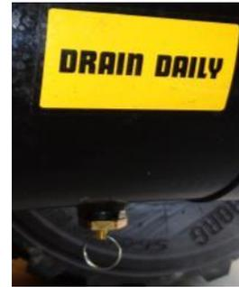
Drucklufttank mit Ablassventil
