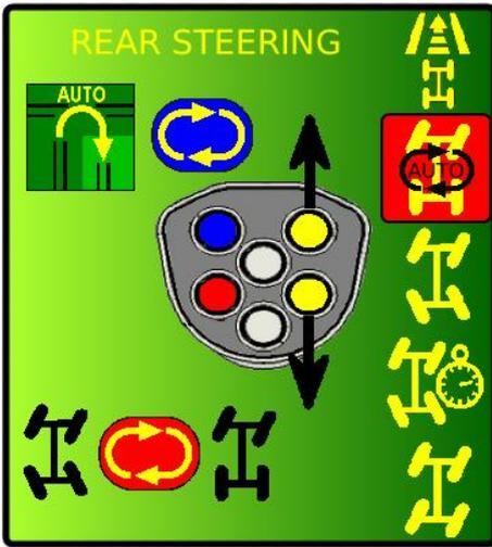
Die blaue Joystick-Taste schaltet den Vorgewende-Modus ein und aus. Der Vorgewende-Modus ist nur dann verfügbar, wenn der Haupt-Betriebsmoduswähler auf Zweiradlenkung / Auto steht. Das Symbol des Vorgewende-Modus leuchtet auf, wenn der Modus ausgewählt wird. Im Vorgewende-Modus schaltet die Lenkung vom Zweirad- in den Vierradmodus um, wenn die Spritzanlage mit dem grünen Knopf ein- bzw. ausgeschaltet wird.
