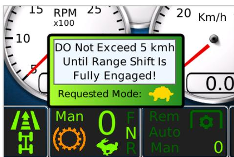
Nur selten geschieht das Umschalten sofort. Das Pop-up-Fenster zeigt an, dass auf das Umschalten in die langsamen Gänge gewartet wird. Die untere Anzeige zeigt an, dass derzeit die schnellen Gänge gewählt sind. Um den Schaltvorgang einzuleiten, ist es am einfachsten, kurzzeitig die Richtung zu ändern. Das Pop-up-Fenster schließt sich und das untere Symbol zeigt den derzeit gewählten Übersetzungsmodus an.
