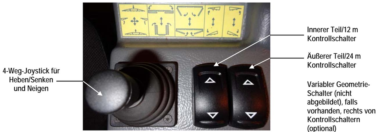
Normalerweise muss der Motor zum Ein- und Ausklappen des Gestänges nur im Leerlauf betrieben werden. In der Nähe der Schalter sind Schilder platziert, die den Betrieb der Gestängesteuerung erläutern.
