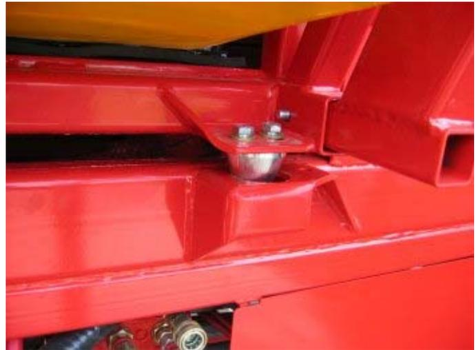
**Das Kegel-Leitsystem richtet den Rahmen beim Wiedereinbau automatisch aus.**
