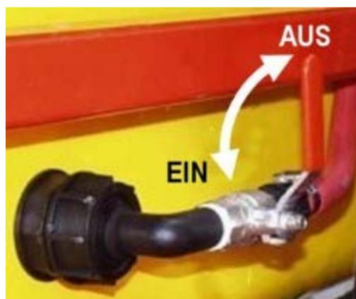
Regelventil der Rührvorrichtung
