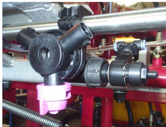
Düsenkörper mit Druckluft-aktiviertem Rückschlagventil
