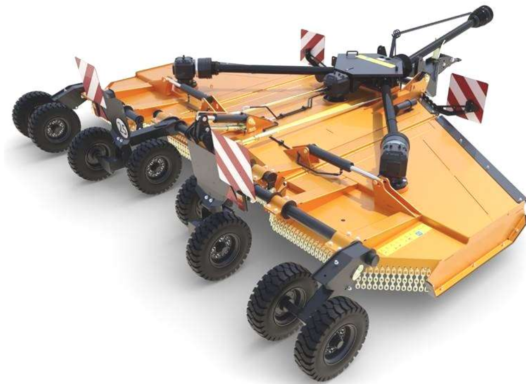
Figure 1.1 Tondeuse tractée Flexwing Tuffcut de McConnel (modèle 480 représenté)
