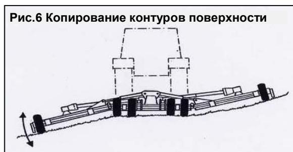
**ВАЖНАЯ ИНФОРМАЦИЯ:** Не эксплуатируйте машину на неровной местности при ограничителе высоты, т.к. любые ударные нагрузки могут вызвать механическое напряжение, приводящее к износу и поломкам. Поддерживайте вес в системе газозвеси посредством удаления штыря-ограничителя высоты.
