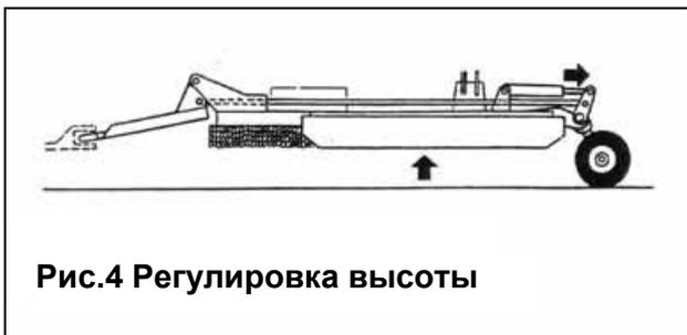
Рис.4 Регулировка высоты
