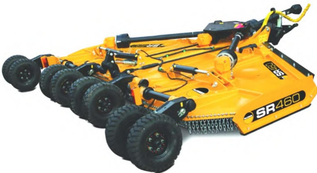
**Abbildung 1.1 SR-Serie mit flexiblen Seitenteilen**
