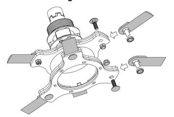
**Locking Bolt** (Part No. 2770681) 6 per rotor unit / 18 per machine
