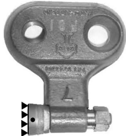
Bestes Ergebnis, wenn der Teil des Fräszahnes gut scharf ist. Drehbar 3 x 120°.
