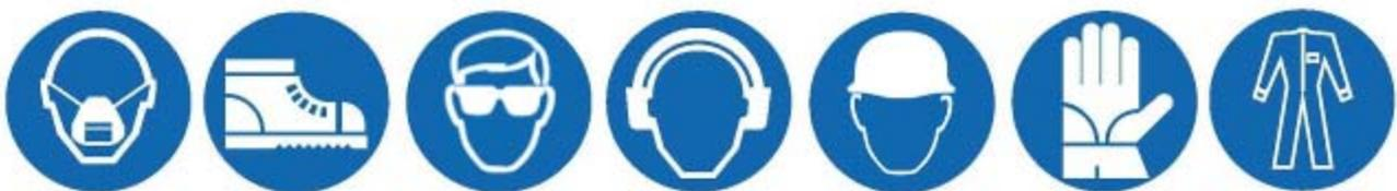
Benutzer sollten beim Betrieb der Maschine stets geeignete Schutzausrüstung tragen. *Folgende Schutzausrüstung wird empfohlen:*
