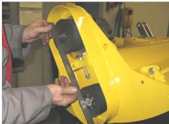
Vergewissern Sie sich, ehe Sie die Maschine in Betrieb nehmen, dass alle Verbindungen richtig angezogen worden sind und die Abdeckung des Antriebsriemens angebracht worden ist.
