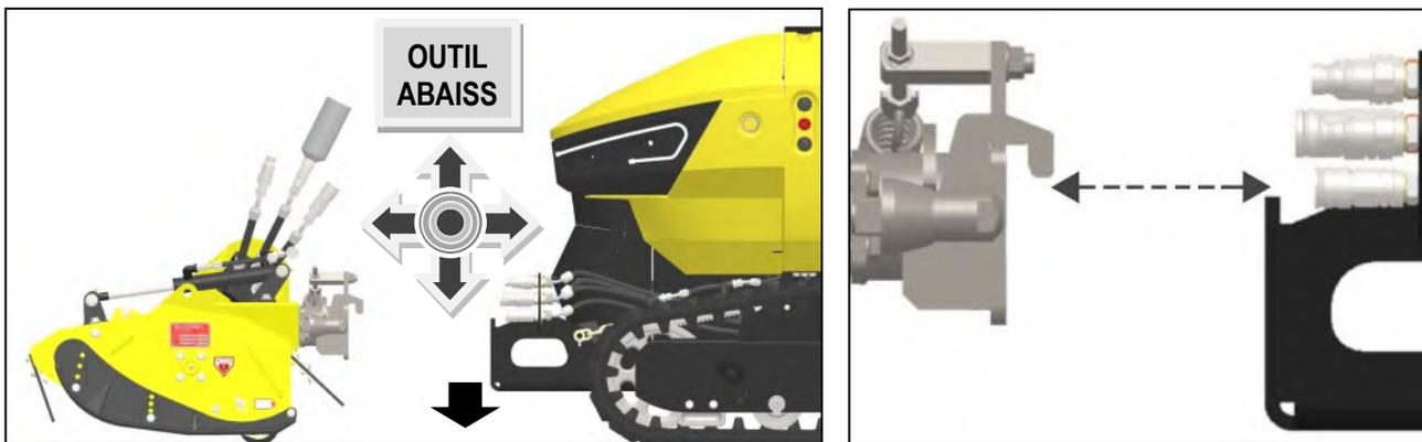
4) Faites avancer le Robocut lentement jusqu'à ce qu'il soit en contact avec le support de montage de la tête de fléau.
