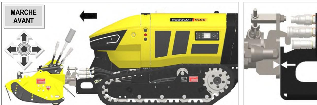
5) Soulevez la barre d'outils du Robocut pour la connecter aux ferrures d'attache du support de montage de la tête de fléau.
