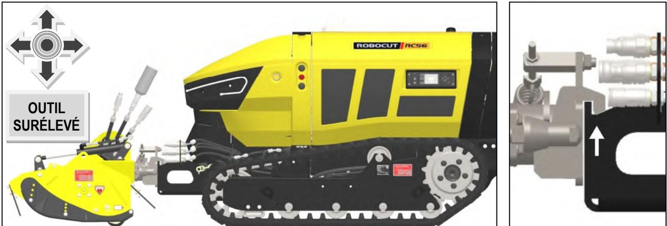
6) Fixez la tête de fléau à la barre d'outils du Robocut à l'aide des fixations de la tête de fléau (6 écrous et boulons) - serrez les fixations à fond
