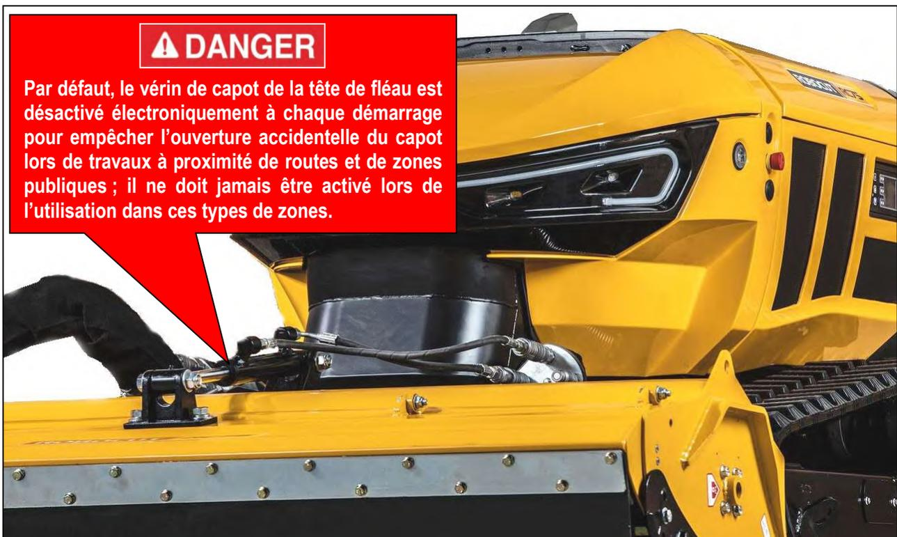
Sur les machines équipées d'une tête de fléau d'herbe, l'écran d'avertissement du capot s'affiche toujours au démarrage ; il revient à l'opérateur de s'assurer que toutes les conditions de sécurité sont remplies avant de sélectionner l'option d'activation du capot. Les opérateurs de cette machine sont responsables de la sécurité de toutes les personnes et de tous les biens à proximité de la machine de travail ; en cas de doute, le travail ne doit être effectué que lorsque le capot est désactivé.
