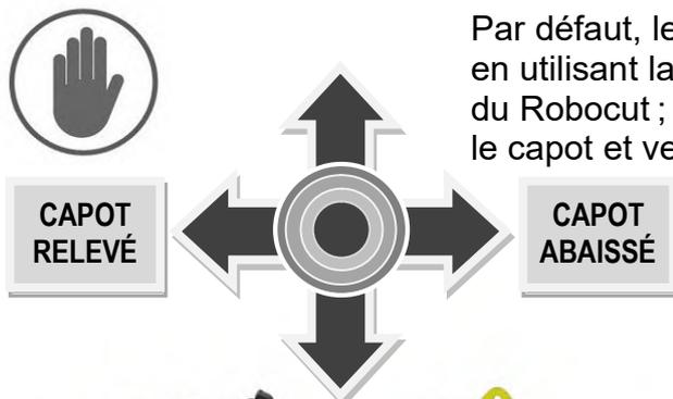
Par défaut, le fonctionnement du capot avant est contrôlé en utilisant la manette de gauche sur les télécommandes du Robocut ; déplacez la manette vers la gauche pour lever le capot et vers la droite pour l'abaisser.
