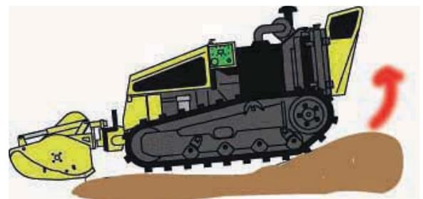
Éviter de procéder le long du marge d'une pente ou sur un terrain accidenté avec une chenille horizontale et l'autre inclinée ou partiellement soulevée (avec la machine inclinée de plus de 10° environ). Pour ne pas endommager les chenilles, procéder toujours avec les patins appuyés sur le même plan horizontal.
