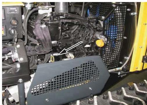
Contrôler que le niveau d'huile hydraulique du réservoir se situe dans les limites prévues, tel qu'on l'indique.
