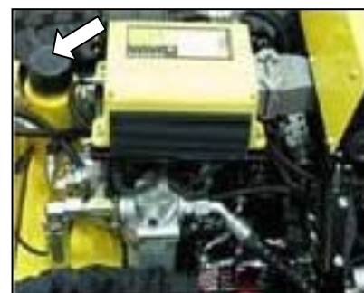
Placering av hydrauloljetankens påfyllning
