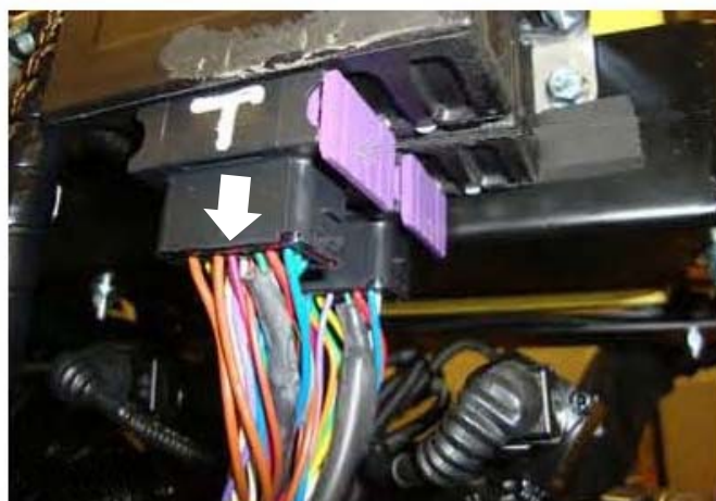
Lossa kablagets kontaktdon från bromskontrollmodulen för att maskinen ska kunna köras med det manuella manöverdonet
