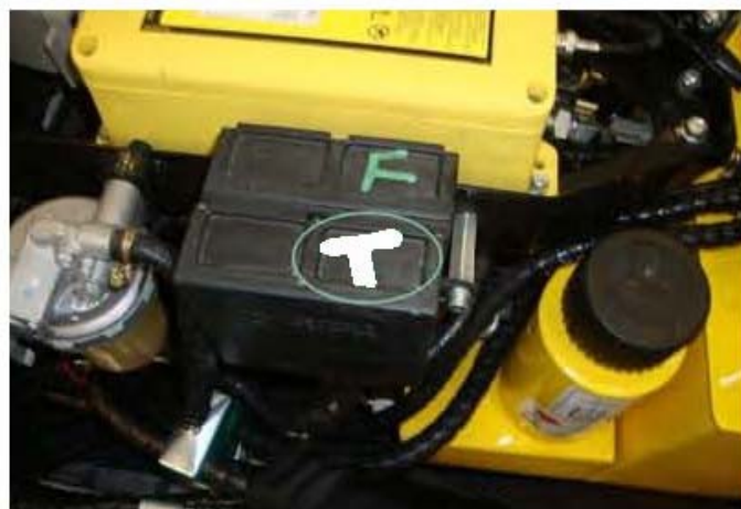
Bromskontrollmodulens identifiering (markerad med 'T')
