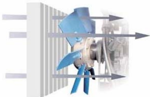
Normalus ventiliatoriaus funkcionavimas ▲ – per radiatorių traukiamas aušinantis oro srautas
