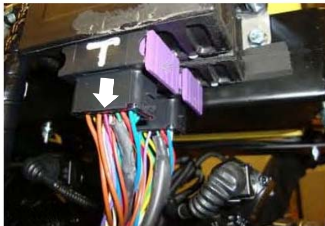
Atjunkite sujungimo kontūrą nuo stabdžių valdymo modulio mašinos valdymui rankinio valdymo bloku
