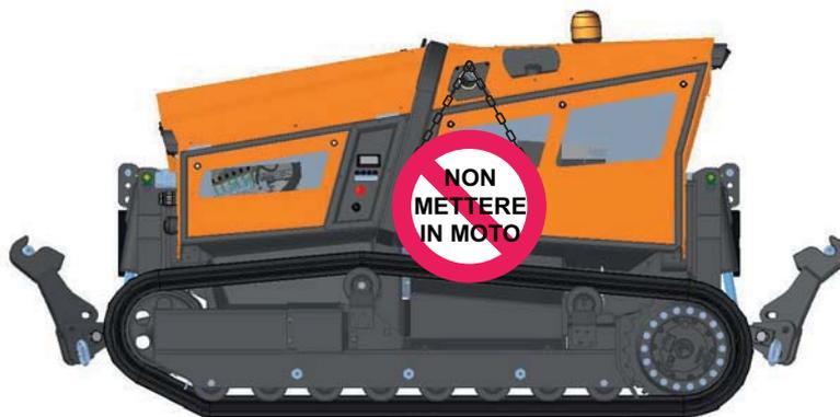
Ein Warnschild "NICHT STARTEN" an die Maschine anbringen. Den Zündschlüssel vor der Durchführung von Wartungsarbeiten oder Kontrollen abziehen.
