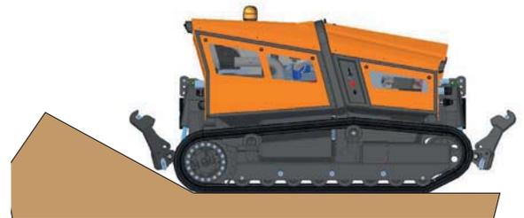
Nicht entlang eines Abhangs oder auf einem unebenen Gelände fahren, wenn eine horizontale und eine geneigte oder teilweise angehobene Raupenkette (mit der Maschine um mehr als etwa 10° geneigt) verwendet wird. Um die Beschädigung der Raupenketten zu vermeiden, stets mit auf demselben horizontalen Boden aufgesetzten Kufen fahren.
