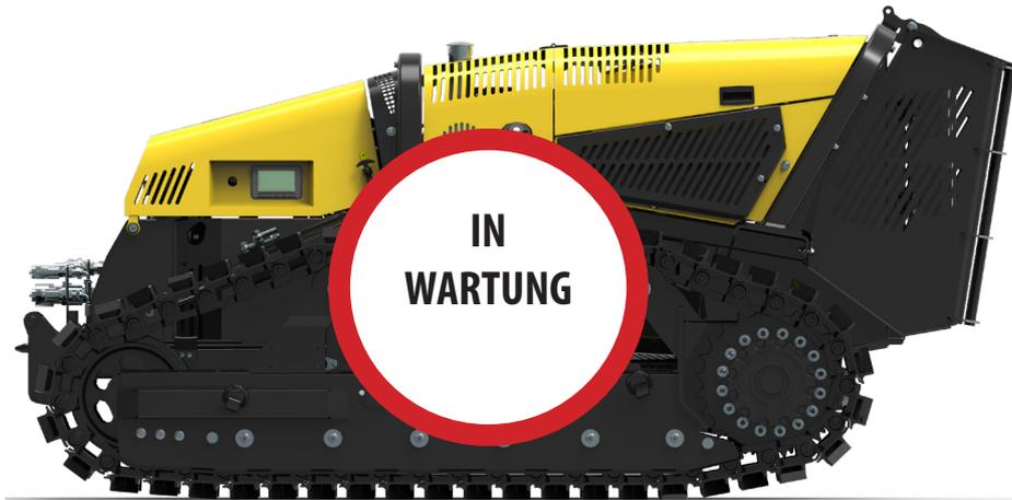
Ein Warnschild "**WARTUNG WIRD AUSGEFÜHRT**" an die Maschine anbringen. Den Zündschlüssel vor der Durchführung von Wartungsarbeiten oder Kontrollen abziehen.
