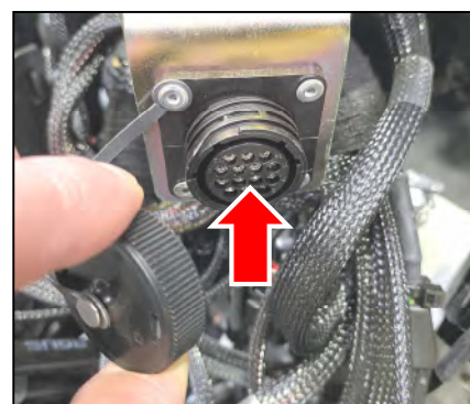
Amplasarea și identificarea punctului de conectare a unității de comandă de urgență
