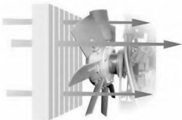
Flux de aer prin radiator pentru răcire
