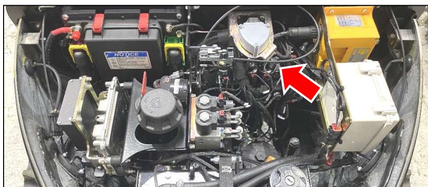
Amplasarea și identificarea punctului de conectare a unității de comandă de urgență
