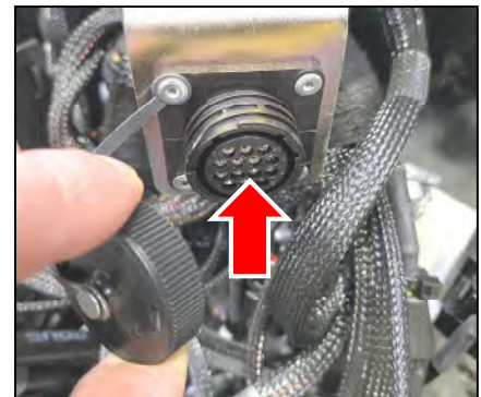
Lage und Identifikation des Anschlusspunktes des Notfallsteuergerätes
