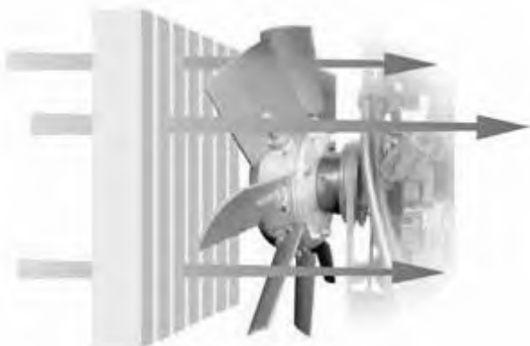
Luftstrom durch den Kühler zur Kühlung
