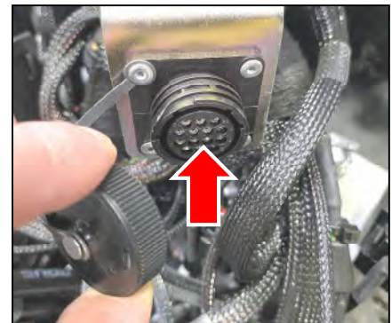
Lage und Identifikation des Anschlusspunktes des Notfallsteuergerätes
