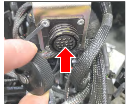
Lage und Identifikation des Anschlusspunktes des Notfallsteuergerätes
