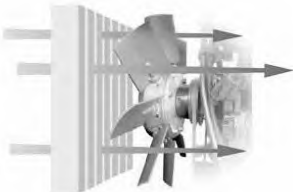
Luftstrom durch den Kühler zur Kühlung
