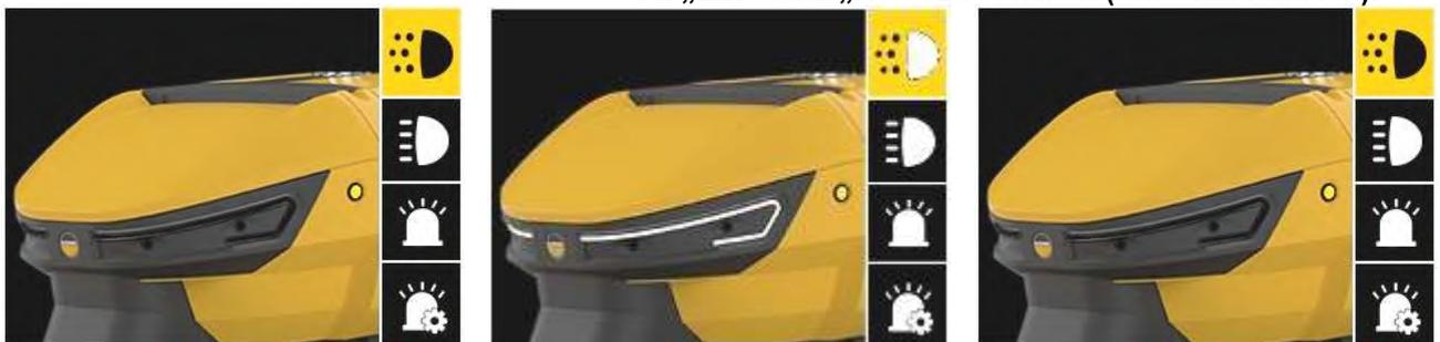
Standardmäßig sind die Tageslichter so voreingestellt, dass sie beim Einschalten „EIN“-geschaltet werden und in 2 Anzeigemodi arbeiten: wenn die Fernbedienung nicht synchronisiert ist, werden die Lichter pulsieren, wenn die Fernbedienung synchronisiert ist, werden die Lichter konstant eingeschaltet.
