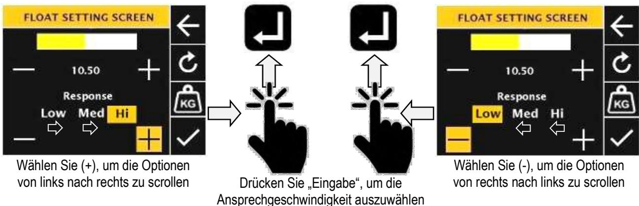
Die Standardeinstellung der Gleit-Ansprechgeschwindigkeit ist **NIEDRIG**: Dies ist die empfohlene Option für normale Arbeiten und Bedingungen.
