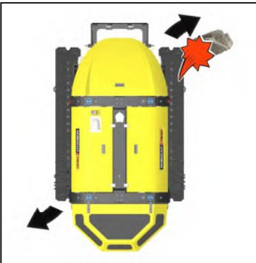
**⚠ VORSICHT** Wenn die Maschine die Richtung wechselt und sich die Kette aufgrund eines Hindernisses nicht seitlich bewegen kann, besteht die Gefahr, dass die Kette beschädigt wird oder von ihrem Sitz abfällt. Vermeiden Sie nach Möglichkeit, die Maschine zu drehen, wenn sie gegen ein Hindernis stößt, und führen Sie, falls unvermeidlich, langsame und allmähliche Manöver durch, bis sie sich vom Objekt entfernt.
