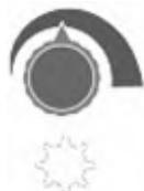
**Erhöhung der Rotordrehzahl** Den Drehknopf im Uhrzeigersinn drehen
