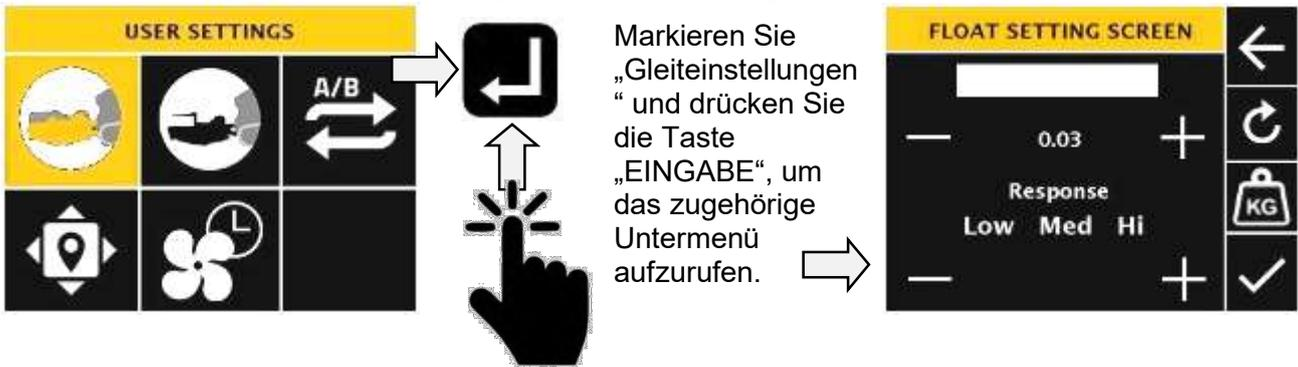
Verwenden Sie die Navigationstasten
