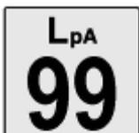
**LpA** – der Wert gibt den maximalen Schallpegel an, den der Bediener in einem Abstand von 1 m von der Maschine wahrnimmt.
