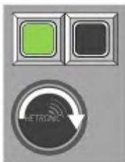
Schalten Sie die Fernbedienung EIN, indem Sie den Einschalter im Uhrzeigersinn drehen; die Steuerung gibt eine Reihe von Summtönen von sich und der Bildschirm zeigt das Symbol „Unsynchronisiert“ an.
