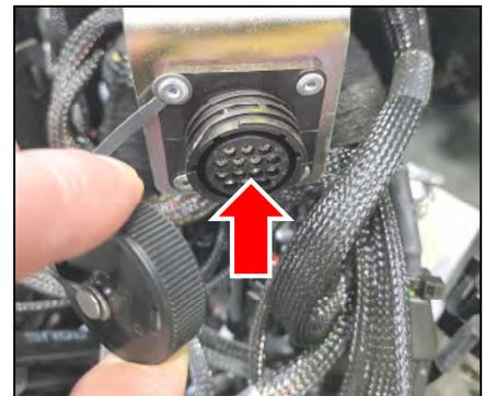
Lage und Identifikation des Anschlusspunktes des Notfallsteuergerätes
