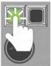
Drücken Sie die GRÜNE Taste auf der rechten Seite der Fernbedienung, um die Fernbedienung mit der Maschine zu verbinden; die Hupe ertönt und die Beleuchtung der Maschine wechselt in den Modus „permanent eingeschaltet“.
