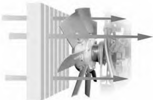
Air au travers du radiateur pour refroidissement
