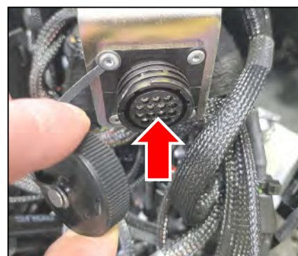
Emplacement et identification du point de branchement du module de commande d'urgence
