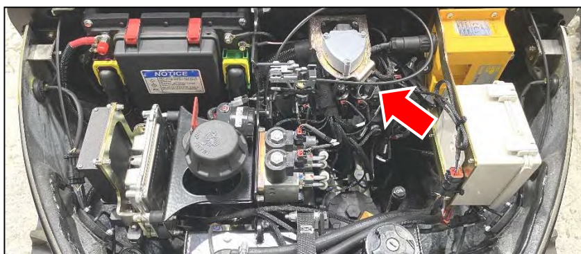
Emplacement et identification du point de branchement du module de commande d'urgence
