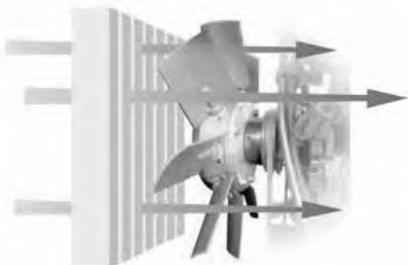
Air au travers du radiateur pour refroidissement
