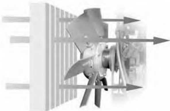
Luchtstroom door radiator voor koelen
