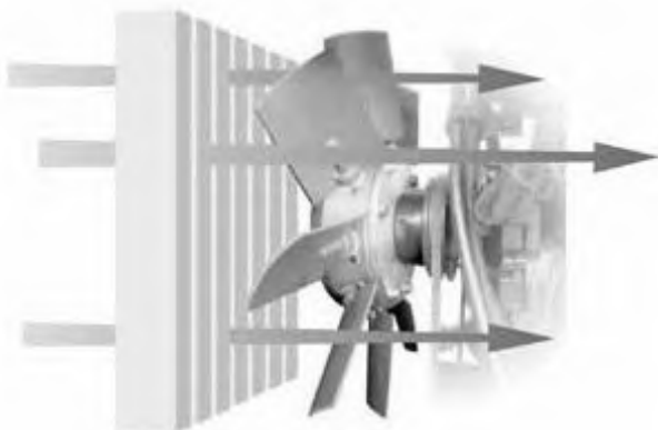
Luchtstroom door radiator voor koelen
