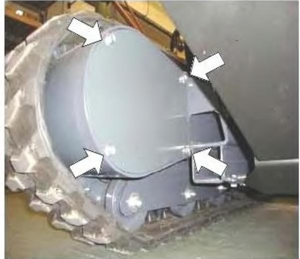
Entfernen Sie die Staubschutzabdeckung aus Gummi von der Zugangsöffnung zur Bremslösung.
