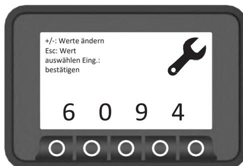
Alle 50 Stunden werden Sie von der Maschine zur Inspektion aufgefordert, danach muss der Wartungsfehler zurückgesetzt werden.
