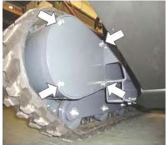
Retirer le cache-poussière en caoutchouc de l'orifice d'accès au dispositif de déblocage des freins.
