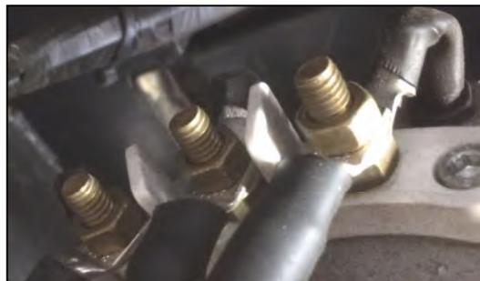
**Lage der Stromkabel der Kettenmotoren: Zum Abschleppen müssen die 3 Stromkabel an jedem Motor abgeklemmt werden.**
