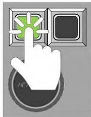
Drücken Sie die GRÜNE Taste auf der rechten Seite der Fernbedienung, um diese mit der Maschine zu paaren.
