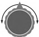
**Drehknopf gegen den Uhrzeigersinn drehen = Höchstgeschwindigkeit wird reduziert**
