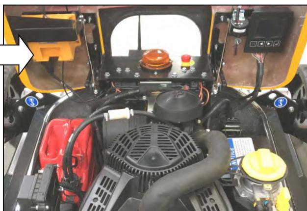
*Die Ladestation versorgt die Batterie nur bei laufendem Motor mit Strom; das Ladegerät schaltet sich automatisch aus, wenn der Akku seinen voll aufgeladenen Zustand erreicht.*
