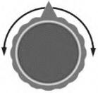
Drehen Sie den Drehknopf nach links, um den gewünschten Grad der linken Lenkungsvorspannung auszuwählen.
