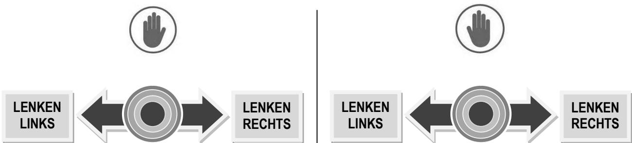
HINWEIS: Wenn die Joysticks gleichzeitig in entgegengesetzte Richtungen betätigt werden, hat der RH-Joystick Vorrang.
