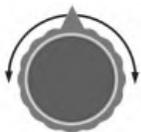
Tourner le bouton de commande vers la gauche pour sélectionner la compensation de direction vers la gauche souhaitée.
