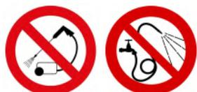
**NE PAS** utiliser de nettoyeur haute pression ou de tuyau d'arrosage pour nettoyer la machine.
