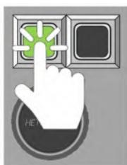
Appuyer sur le bouton VERT situé sur le côté droit du module de télécommande pour appairer ce dernier avec la machine.
