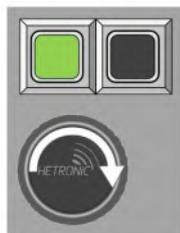
Mettre le module de télécommande sous tension en tournant l'interrupteur dans le sens horaire ; le module émet une série de « bourdonnements » et l'écran affiche le symbole « non synchronisé ».
