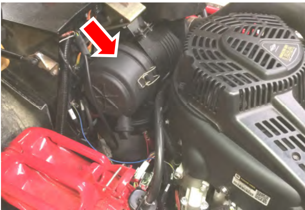
Logement de filtre à air
