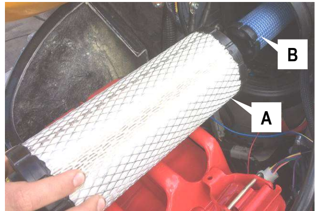
A) Primair filter B) Secundair filter
