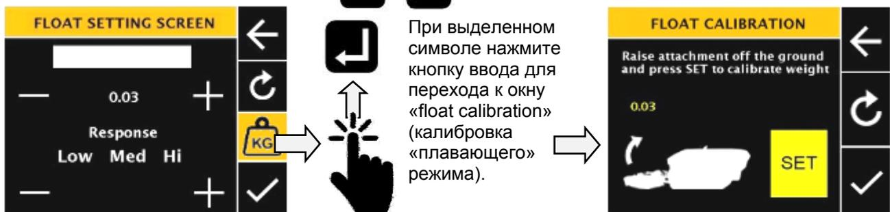
При выделенном символе нажмите кнопку ввода для перехода к окну «float calibration» (калибровка «плавающего» режима).
