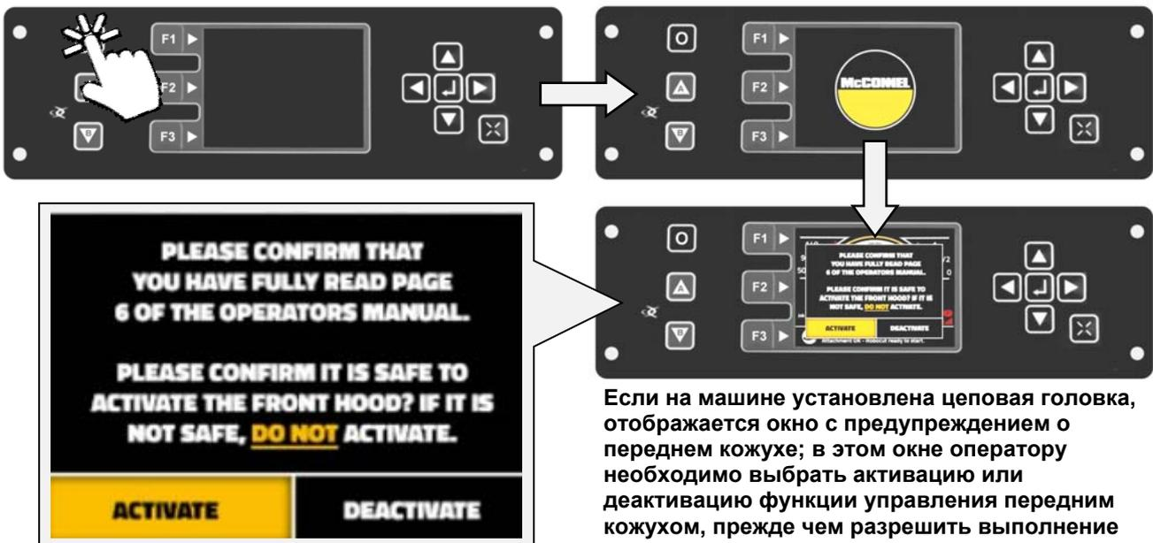
Если на машине установлена цеповая головка, отображается окно с предупреждением о переднем кожухе; в этом окне оператору необходимо выбрать активацию или деактивацию функции управления передним кожухом, прежде чем разрешить выполнение синхронизации машины.
