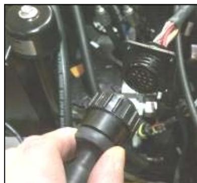
Расположение и внешний вид точки подсоединения устройства аварийного управления
