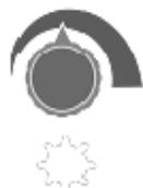
**Повышение оборотов ротора:** поворачивайте регулятор по часовой стрелке
