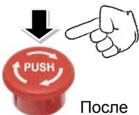
В аварийных ситуациях двигатель и все функции машины можно немедленно остановить нажатием кнопки аварийного останова.
