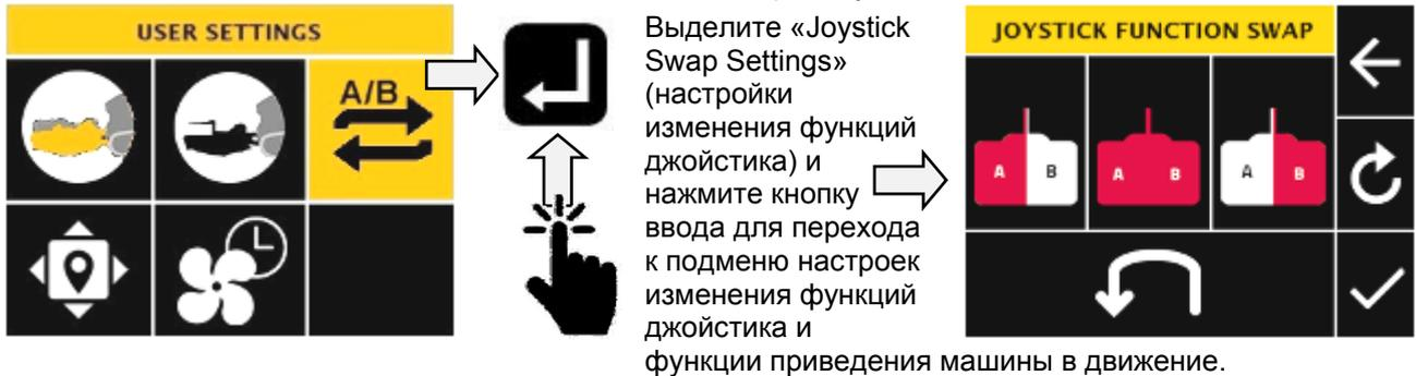
Выделите «Joystick Swap Settings» (настройки изменения функций джойстика) и нажмите кнопку ввода для перехода к подменю настроек изменения функций джойстика и функции приведения машины в движение.
