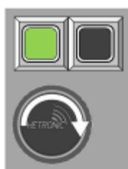
Включите пульт дистанционного управления повернув выключатель питания по часовой стрелке; пульт управления издаст серию «жужжащих» звуков, на дисплее отобразится синхронизации.
