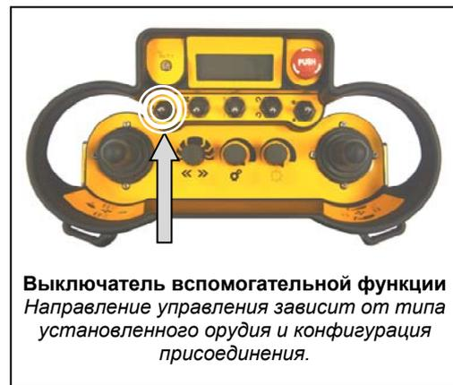
Выключатель вспомогательной функции
