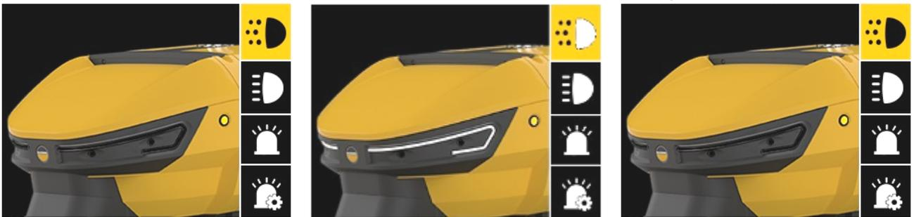
По умолчанию фары дневного света установлены на ВКЛ при запуске и работают в 2 режимах индикации; если пульт дистанционного управления не синхронизирован, фары будут «пульсировать», если пульт синхронизирован, фары будут гореть постоянно.
