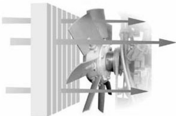
Légáram a hűtőn keresztül a hűtéshez
