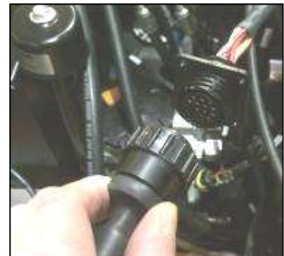
Lage und Identifikation des Anschlusspunktes des Notfallsteuergerätes
