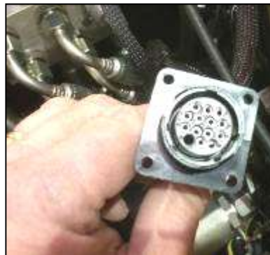
Lage und Identifikation des Anschlusspunktes des Notfallsteuergerätes
