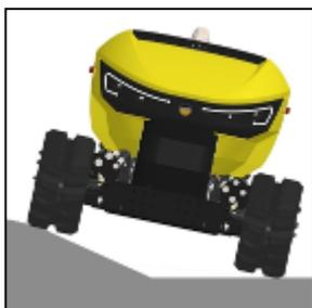
**⚠ ATTENTION** Ne pas effectuer de déplacement le long du bord d'une pente ou sur un sol irrégulier, avec une chenille en position horizontale et l'autre inclinée ou partiellement relevée lorsque la machine se trouve à un angle de plus de 10°. Pour éviter un risque d'endommagement des chenilles, procéder toujours avec les deux chenilles en déplacement sur le même plan horizontal.
