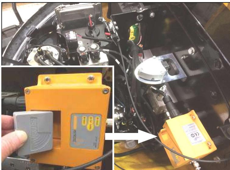
Emplacement du poste de charge de la batterie de télécommande
