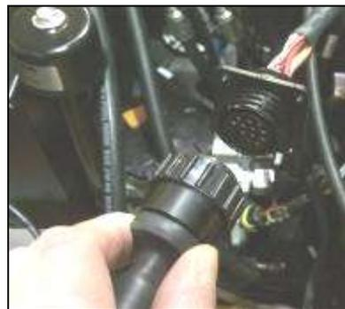
Emplacement et identification du point de branchement du module de commande d'urgence
