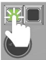
Appuyer sur le bouton VERT situé sur le côté droit du module de télécommande pour appairer le module de télécommande avec la machine ; l'avertisseur sonore se fait entendre et les feux de la machine passent en mode « permanent ».
