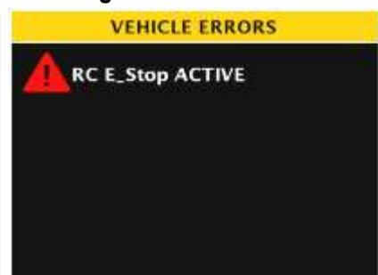
Si une erreur véhicule s'affiche, il convient de vérifier la cause et de prendre des mesures appropriées pour rectifier le problème et effacer l'erreur. L'exemple d'erreur présenté ci-dessus (**Arrêt urgence RC ACTIF**) est un message que le système envoie lorsque la machine ne détecte pas de signal radio en provenance du module de télécommande ; une mise sous tension du module de télécommande et une synchronisation de la commande avec la machine effacent ce message d'erreur.
