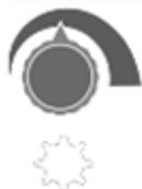
**Augmentation de la vitesse de rotation du rotor** : rotation du bouton de commande dans le sens horaire
