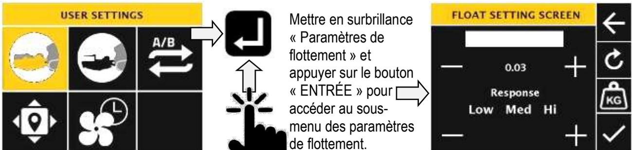
Utiliser les boutons de navigation ▼ et ▲ pour sélectionner l'icône de poids.
