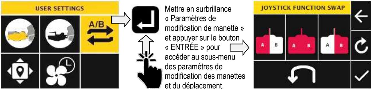
Pour modifier les fonctions des manettes, consulter les paramètres ci-dessous – si une modification des fonctions des manettes et du sens de déplacement est requise, se référer aux paramètres présentés à la page suivante.
