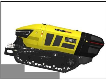
**⚠ ATTENTION** Lorsque la machine manœuvre au-dessus d'un obstacle, un espace se crée entre les galets de soutien et la chenille – ceci peut déloger la chenille des saillies de guidage. La même situation peut se produire en marche arrière lorsqu'un espace se crée entre le galet de soutien, la roue folle et la bande de guidage. Pour éliminer ce risque, des guides de chenille sont fournis à la partie avant du train chenillé.
