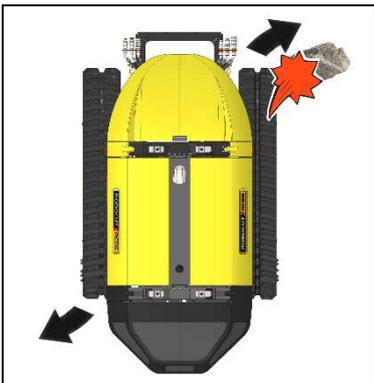
**⚠ ATTENTION** Si la machine change de direction et que la chenille ne peut pas se déplacer de côté en raison de la présence d'un obstacle, la chenille risque d'être endommagée ou de sortir de son guide ; dans la mesure du possible, éviter de tourner la machine si elle se trouve contre un obstacle et, si cela est inévitable, effectuer les manœuvres lentement et progressivement jusqu'à ce que la machine soit éloignée de l'objet.
