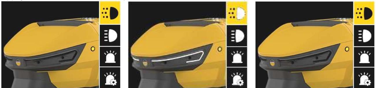
Par défaut, les feux de jour sont pré réglés pour s'allumer au démarrage et fonctionner en 2 modes d'indication ; si la télécommande n'est pas synchronisée, les feux « pulsent » mais il restent allumés en permanence lorsque la télécommande est synchronisée.
